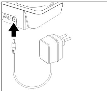
1. Stecken Sie den kleinen Stecker am anderen Ende des Kabels in die Buchse **DC IN [11]** an der Sender-Station.
