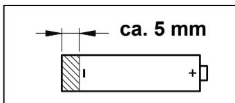
**HINWEIS:** Bei den mitgelieferten Akkus wurden am – Pol ca. 5 mm der Ummantelung entfernt. Falls Sie später die Akkus durch andere Akkus des gleichen Typs (1,2 V / 1050mAh / Ni-MH Typ R03 / AAA) ersetzen möchten, müssen Sie von diesen ebenfalls ca. 5 mm der Ummantelung am – Pol (vgl. Abbildung) entfernen.
