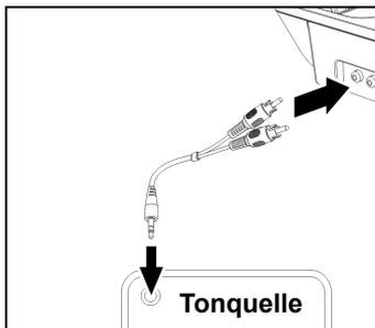
3. Schließen Sie das Audiokabel **[15]** mit den Cinch-Steckern in die farblich entsprechenden Buchsen **AUDIO IN R L [12]** an der Rückseite der Sender-Station.
