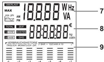
7. Anzeigebereich für Spannung, Strom, Leistung, Frequenz, Leistungsfaktor und Überlast.
