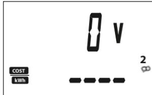
Im Display werden 4 Striche angezeigt. Dies bedeutet, dass kein zweiter Preis für Nachtstrom berücksichtigt wird.
