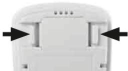
2. Compressez les deux ressorts d'engagement latéraux du logement de la pile simultanément et sortez le logement de la pile de l'appareil.
