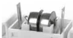
5. Insérez le logement de la pile avec les deux ressorts de contact dans les fentes de l'appareil et pressez jusqu'à ce qu'il s'engage.
