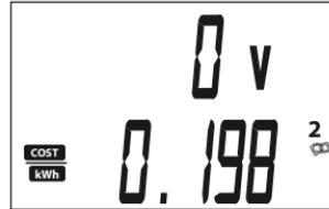
13. Druk na de prijsinvoer nog een keer op de toets **OK**. In het display wordt nu **TIME** weergegeven. Voer hier de kloktijd in, vanaf welke de dure dagstroom berekend wordt.
