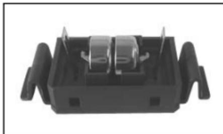
4. Setzen Sie 2 neue Batterien (1,5 V Knopfzellen, Typ LR44/AG13) in das Batteriefach ein. Achten Sie beim Einlegen auf die richtige Polarität (+/-), wie auf dem Boden des Batteriefaches abgebildet.
