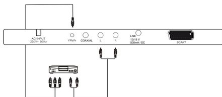
1. Verbinden Sie das mitgelieferte Adapterkabel mit einem im Fachhandel erhältlichen Komponenten-Kabel (3x Cinch).
