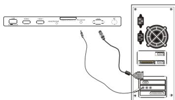
1. Verbinden Sie mit einem VGA-Kabel die Monitor-Buchse des PCs und die Buchse **VGA** am Fernseher.
