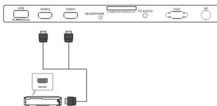
1. Verbinden Sie mit einem im Fachhandel erhältlichen HDMI-Kabel die HDMI-Buchse des externen Gerätes mit der Buchse **HDMI1** oder **HDMI2** am Fernseher. Es können 2 Geräte gleichzeitig angeschlossen werden.
