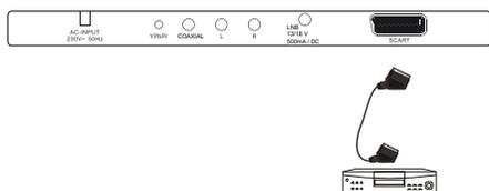
1. Schließen Sie das externe Gerät mit einem voll belegten SCART-Kabel (nicht im Lieferumfang enthalten) an der Buchse **SCART** an.
