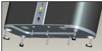
4. Lösen Sie alle 8 Schrauben mit einem Kreuzschlitzschraubendreher.
