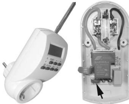
1. Drehen Sie mit einem Kreuzschlitz-Schraubendreher die beiden Schrauben auf der Geräterückseite vollständig heraus.
